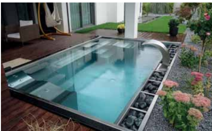
Der Whirlpool 4,5 x 2,6 x 1,4 m mit einseitiger Überlaufrinne ist mit einer Schwalldusche, einer Luftsprudel-Sitzbank und zwei ergonomisch geformten Massageliegen ausgestattet. Die automatische Rollobdeckung mit unterstützendem Solarheizeffekt ist fast unsichtbar in einer Wandnische integriert und elektrisch bedienbar.
