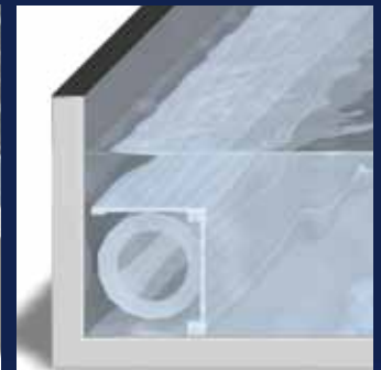
Unterflur – ohne Rolladenschacht mit Sitzbank verkleidet
